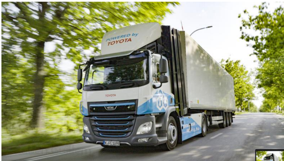
図2. 燃料電池で走るトヨタの大型商用トラック
